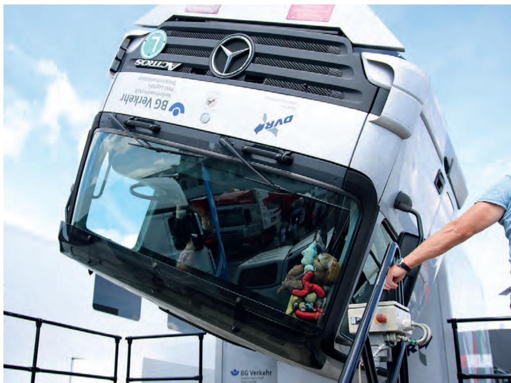
Der Überschlagsimulator zeigt die lebensbedrohlichen Kräfte auf, die bei einem umkippenden Lkw auf den Fahrer wirken. Foto: BG Verkehr
