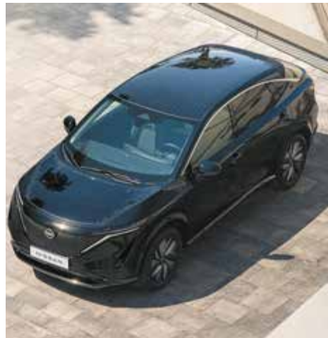
Die Oberfläche von 3,8 Quadratmetern des Nissan Ariya wurde mit Photovoltaikmodulen ausgerüstet, um Sonnenenergie für den Antrieb aufzufangen.
