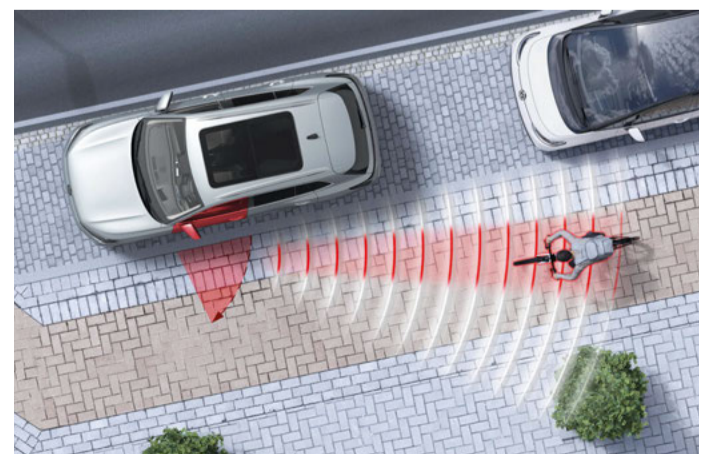
Wenn sich ein anderer Verkehrsteilnehmer beim Aussteigen von hinten nähert, kann die Ausstiegswarnung in verschiedenen Stufen davor warnen. Foto: Volkswagen
