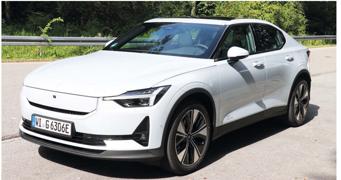
Der Polestar 2 ist technisch grundlegend verändert worden. Die Kraft für die Single-Motoren fließt jetzt auf das Heck.
